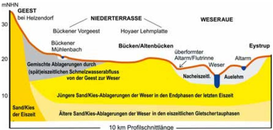
**Abbildung 7:** Vereinfachte Darstellung der geologischen Einheiten im gewählten Ausschnitt des Wesertals. Datenbasis: Höhenprofil nach TK25, geologische Einheiten nach GK25. Der Verlauf des Profilschnitt ist als gelbe Linie in Karte 2 dargestellt.
